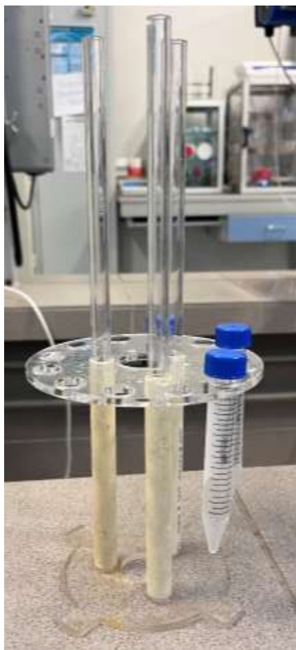
Rys. 16. Uchwyt do umieszczania probówek w reaktorze.
