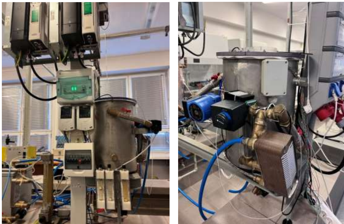
Rys. 13. Fotoreaktor hybrydowy z generatorem pola elektromagnetycznego wykonany w Katedrze Inżynierii Chemicznej i Procesowej ZUT w Szczecinie.
