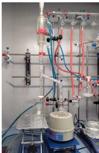
Rysunek 5 Destylacja azeotropowa PEG
