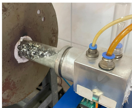
Rys. 34. Dysocjacja gazów mieszaniny \text{NH}_3 + 1\% \text{H}_2\text{S} w rurze kwarcowej wypełnionej katalizatorem (w postaci wiórów stalowych).
