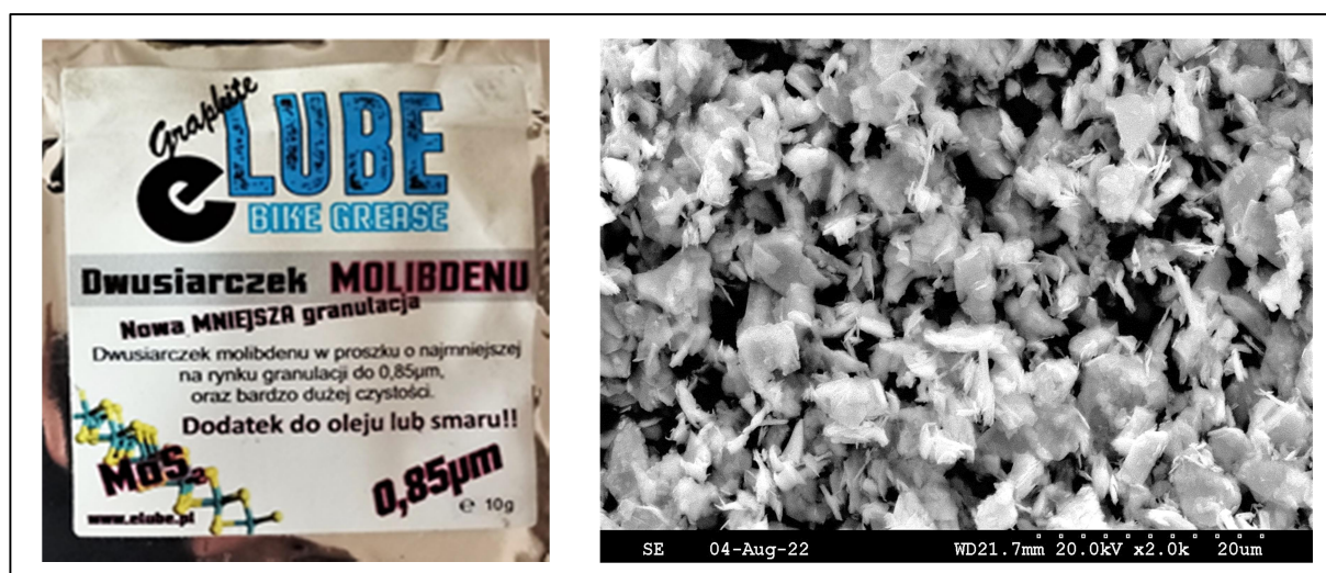
Rys. 26. Etykieta proszku \text{MoS}_2 stosowanego w eksperymentach i jego struktura przy powiększeniu 2000x, SEM.
