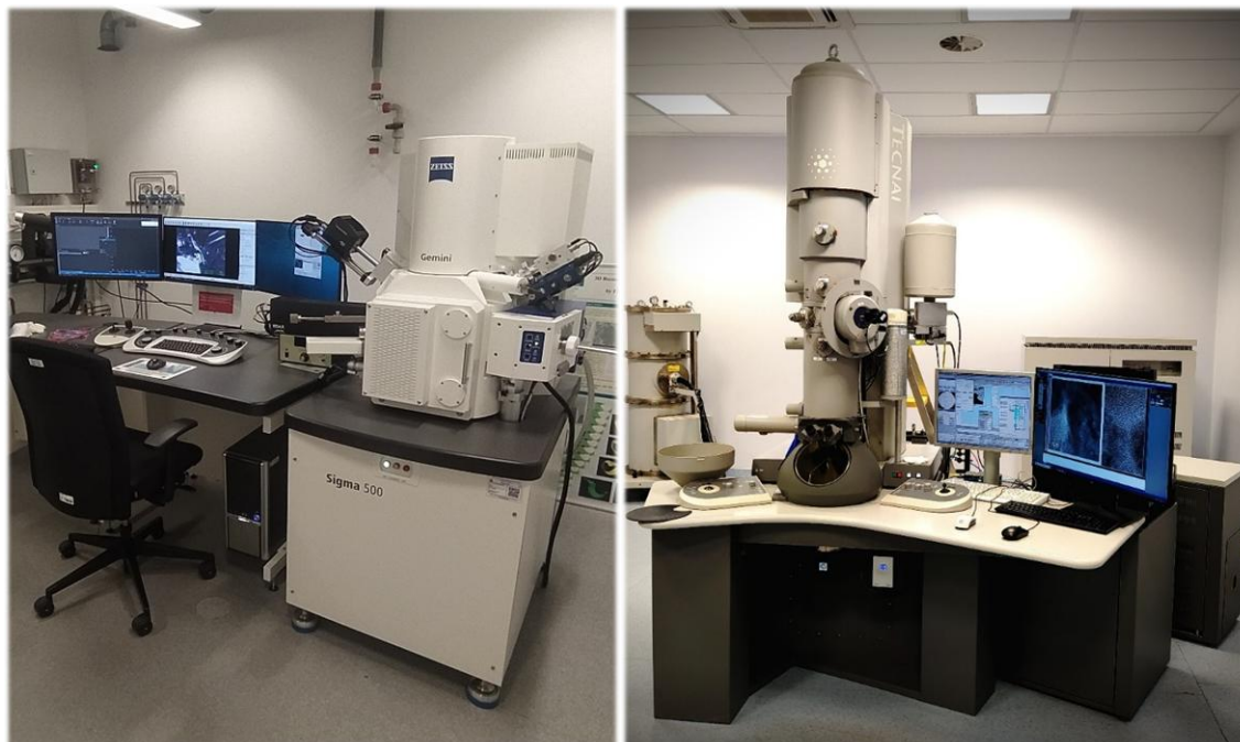
Rysunek 8. (Z lewej) Mikroskop ZEISS Sigma 500, wyposażony w detektory EDS i EBSD, znajdujący się w MPIE Düsseldorf (Niemcy); (Z prawej) Mikroskop FEI Tecnaï G2 F-20S TWIN znajdujący się w Katedrze Fizykochemii Nanomateriałów na ZUT w Szczecinie
