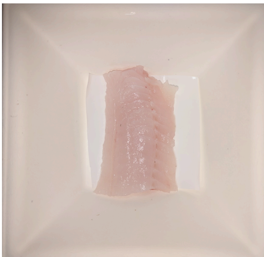
Ryc. 1c Dorsz w pudełku celulozowym z wkładem z folii PE, pokrytej powłoką aktywną z nanocząsteczkami tlenku cynku
