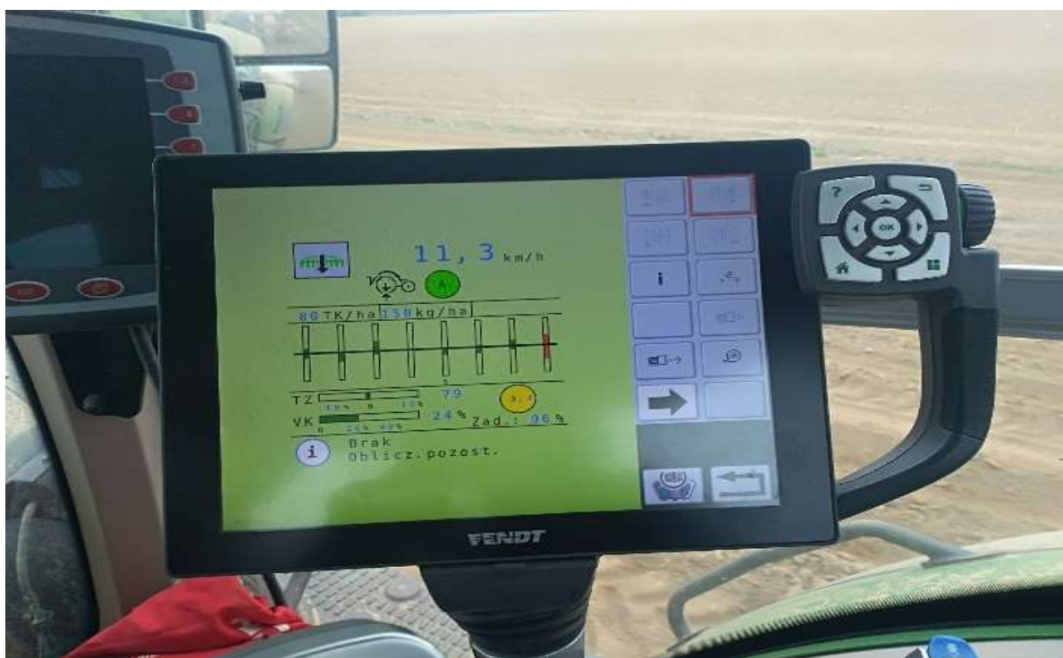
Rys. 3.6. Rzut GPS siewu i nawożenia rejestrowanego z ciągnika Fendt 828. Źródło: własna dokumentacja fotograficzna prowadzonego doświadczenia.
