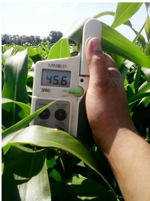
Fot. 5. Pomiar zieloności liści przy pomocy Chlorophyll Meter SPAD 502Plus
