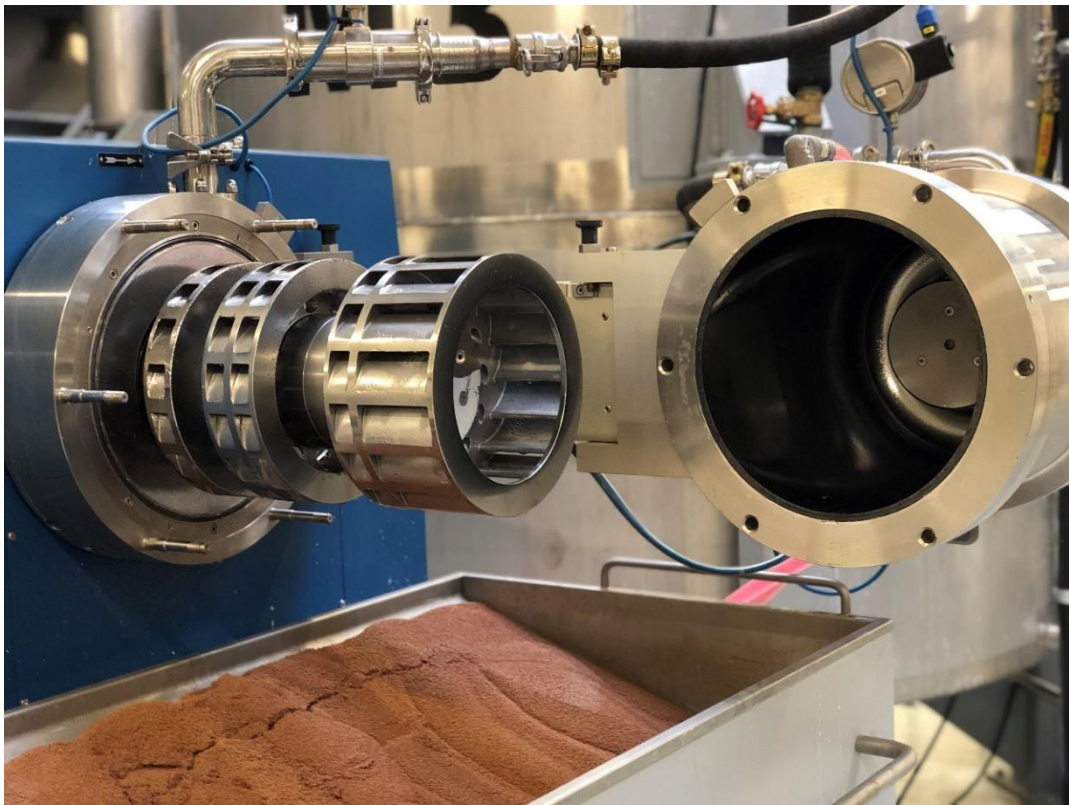
Rys. 6. Otwarta komora młyna perłkowego w hali produkcyjnej [źródło: własne]
