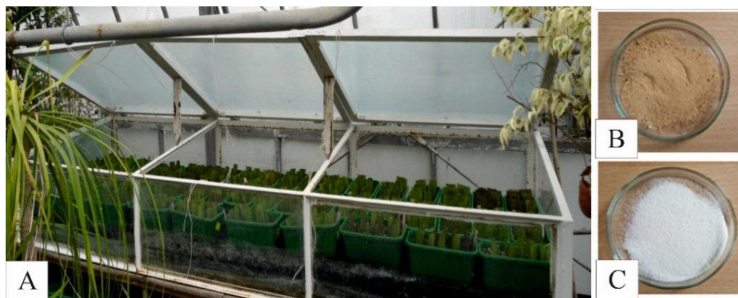
Fot. 8. Mnożarka – A; chitozan o masie cząsteczkowej B – 7000g·mol -1 , C – 10000g·mol -1 (fot. P. Kukła)
