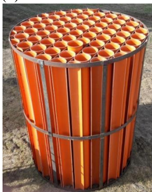
Rys. 6. Wypełnienie fermentatora, złoże szkieletowe wykonane z rur typu pionowego A PVC-U S4 UD umieszczone w widoku kosza: a) brak chropowatości na powierzchni rur; b) chropowatość powierzchni rur po piaskowaniu wynosi 80 \mu\text{m} (fot. Grzegorz Wałowski).
