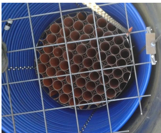
Rys. 8. Złoże szkieletowe umieszczone w fermentatorze - pomiędzy fragment wężownicy - zabezpieczone kratą (fot. Grzegorz Wałowski).
