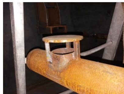
Rys. 7. Układ mieszania substratu w reaktorze widziany od spodu: a) elementy ssące; b) fragment dyszy ssącej (fot. Grzegorz Wałowski).
