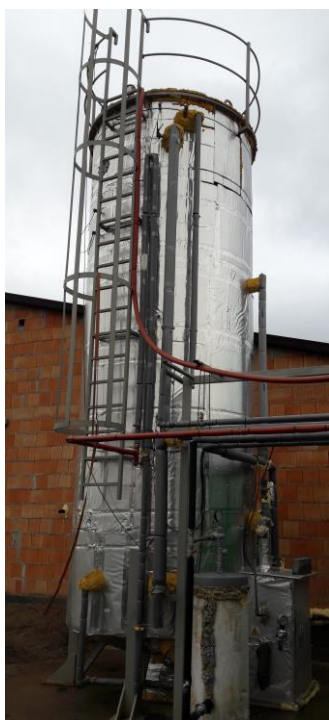
Rys. 5. Monosubstratowy reaktor przepływowy do fermentacji metanowej gnojowicy wraz z fragmentem instalacją do produkcji biogazu – widok (fot. Grzegorz Wałowski).
