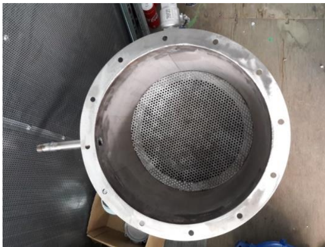
Rys. 15. Odsiarczalniki – wnętrze, pojemność 50 litrów (fot. Grzegorz Wałowski).
