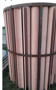
Rys. 6. Wypełnienie fermentatora, złoże szkieletowe wykonane z rur typu pionowego A PVC-U S4 UD umieszczone w widoku kosza: a) brak chropowatości na powierzchni rur; b) chropowatość powierzchni rur po piaskowaniu wynosi 80 \mu\text{m} (fot. Grzegorz Wałowski).
