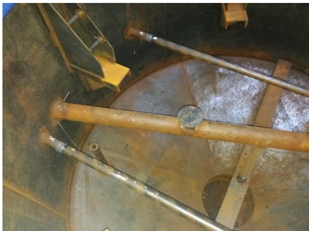
Rys. 7. Układ mieszania substratu w reaktorze widziany od spodu: a) elementy ssące; b) fragment dyszy ssącej (fot. Grzegorz Wałowski).
