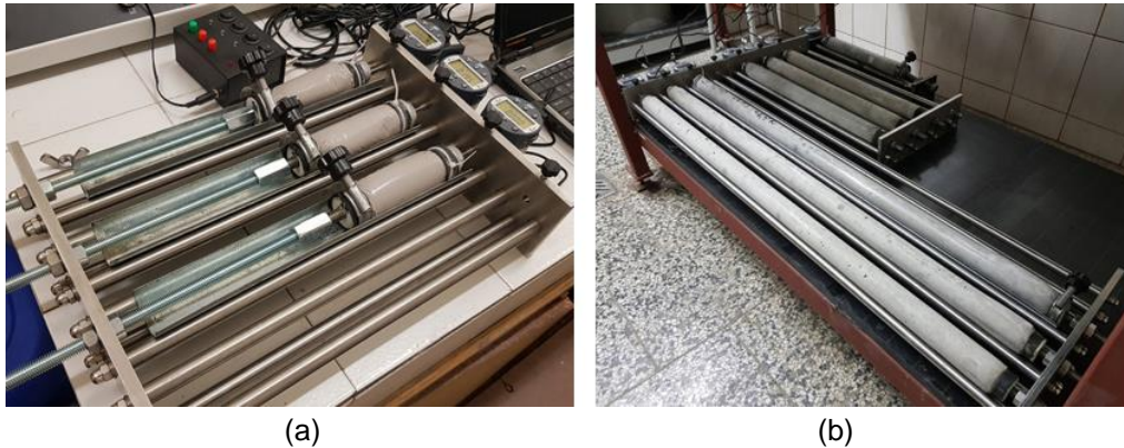
Rys. 16. Regulowana długość docięcia rękawów foliowych umożliwia pomiar różnej długości próbek: (a) badanie eksperymentalnego spoiwa – długość 10 cm, (b) wpływ długości próbek 30, 50 i 100 cm na rejestrację skurczu autogenicznego [R1].
