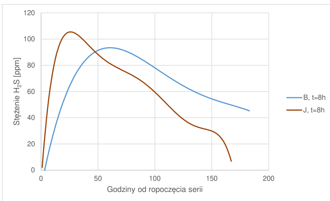
Rys. 53 Stężenia siarkowodoru w czasie trwania całego eksperymentu dla serii B i J (t=8h)
