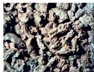
Rys. 9 Drobnoziarniste kruszywo z wypalonego komunalnego osadu ściekowego
