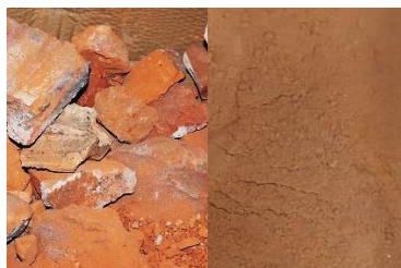
Rys. 2 Zmielony gruz ceglany frakcji 0/0,063
