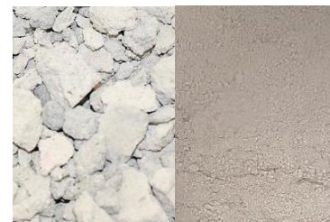
Rys. 3 Zmielony gruz betonowy frakcji 0/0,063
