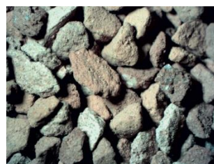
Rys. 8 Drobnoziarniste kruszywo z gruzu ceramicznego
