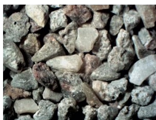
Rys. 7 Drobnoziarniste kruszywo z gruzu betonowego
