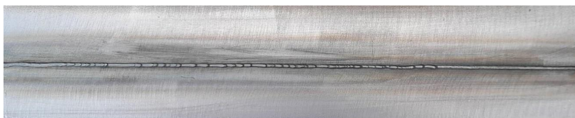
Widok od strony grani spoiny – stan po spawaniu (LM)
