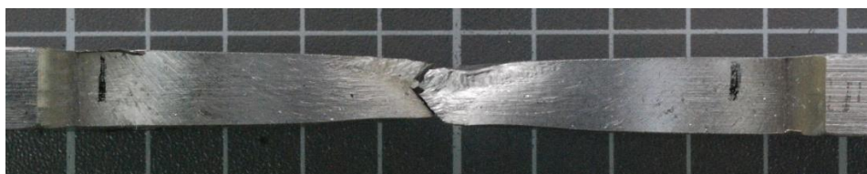
Rys. 7.16 Miejsce przełomu próbek w metalu spoiny po badaniu na rozciąganie poprzeczne – spoina 4.2w (LM)
