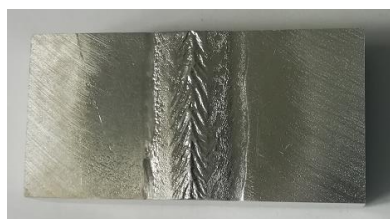
Próbka nr 2 – widok od strony lica
