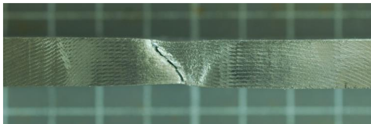
Rys. 7.14 Miejsce przełomu próbek w linii wtopienia po badaniu na rozciąganie poprzeczne – spoina 2.1p (LM)
