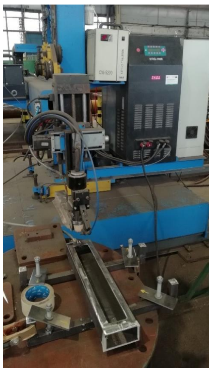
Rys. 6.1 Schemat stanowiska do spawania złącza ze stali duplex
