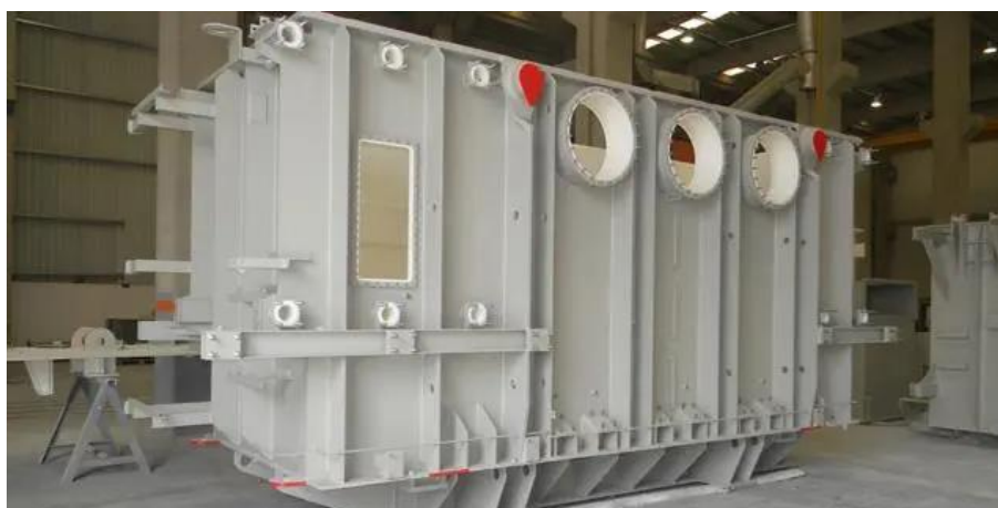
Rysunek 1.10. Kadź transformatora mocy wysokiego napięcia [5]
