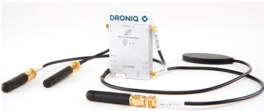
Rys. 2.3 HOD (Hook-On-Device) zaprojektowany dla niemieckiej kontroli ruchu lotniczego DFS oraz Deutsche Telecom.
