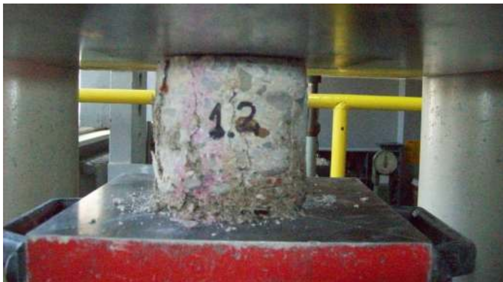
Fot. 44: Przykład badania próbki nr 1.2 w maszynie wytrzymałościowej.
