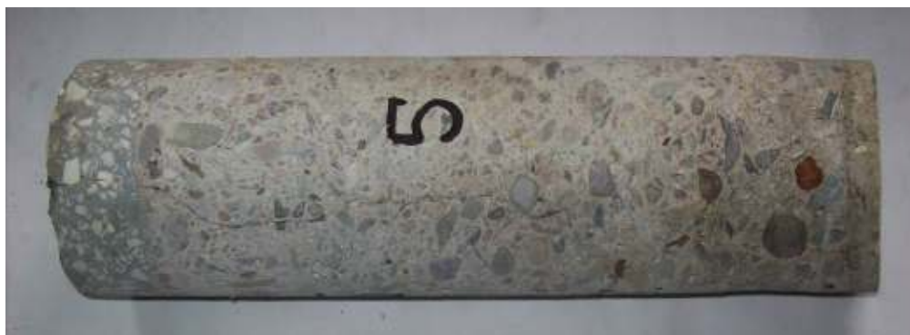
Fot. 41: Odwiert nr 5 o średnicy \varnothing 94 mm: pręt \varnothing 16 w strefie rozciąganej;
