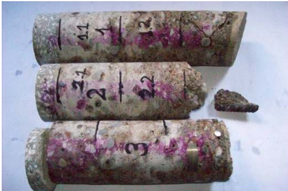
Fot. 42: Próbk nr 1, 2, 3 poddane badaniu roztworem fenoloftaleiny
