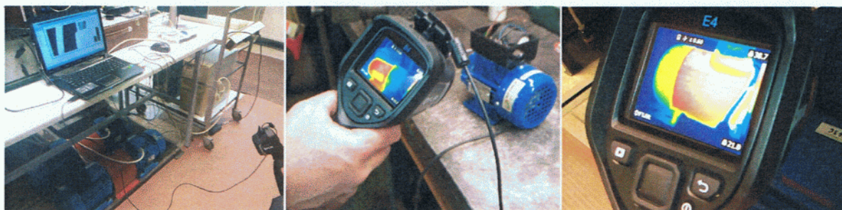
Rys. 2a. Stanowisko do badania sygnałów termowizyjnych wybranych stanów silników elektrycznych wirujących
