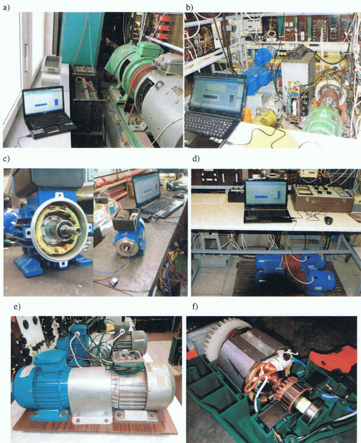
Rys. 1. Ulepszone stanowisko do badania sygnałów akustycznych wybranych stanów silników elektrycznych wirujących, a) badany silnik prądu stałego, b) badany silnik synchroniczny, c) badane jednofazowe silniki indukcyjne, d–e) badane trójfazowe silniki indukcyjne, f) badany silnik komutatorowy elektrycznej wiertarki udarowej.
